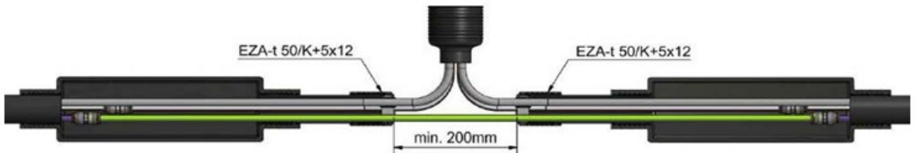
Abbildung 21 Phase 6 eines Abzweiges aus mit einem GfK belegter KR-50 x 4,6mm Trasse mit SNR 12x2mm
