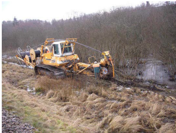
Abbildung 24 Kabellegepflug in Raupenausführung mit Vibrationstechnik (Bild: Fa. Lancier)
