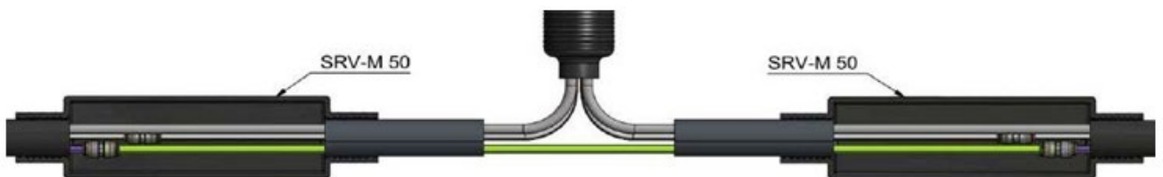
Abbildung 20 Phase 5 eines Abzweiges aus mit einem GfK belegter KR-50 x 4,6mm Trasse mit SNR 12x2mm
